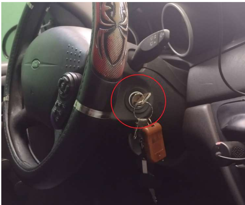
Figura 6.8: Switch y llave original
