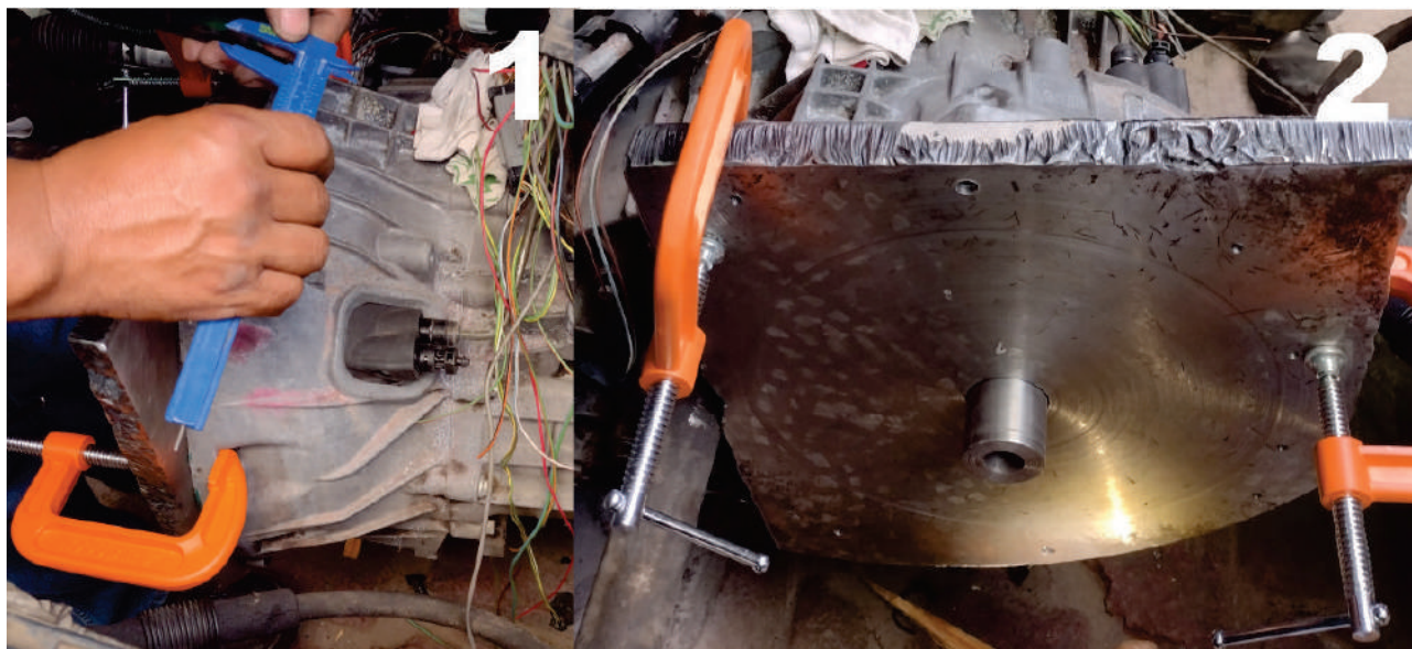
Figura 7.6: Placa adaptadora entre motor eléctrico y caja de velocidades
