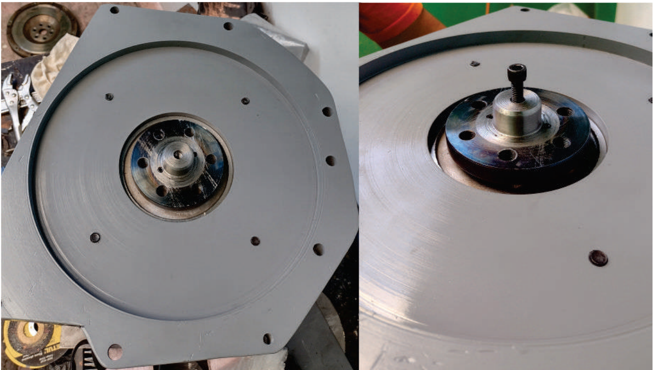
Figura 7.10: Pieza adaptadora y placa atornillados al motor eléctrico
