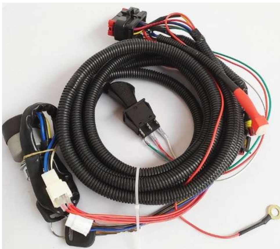
Figura 6.18: Ejemplo de arnes para conexiones de la controladora
