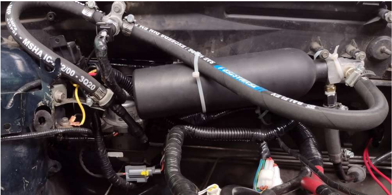
Figura 7.36: Instalación de sensor, tanque de almacenamiento y bomba de vacío
