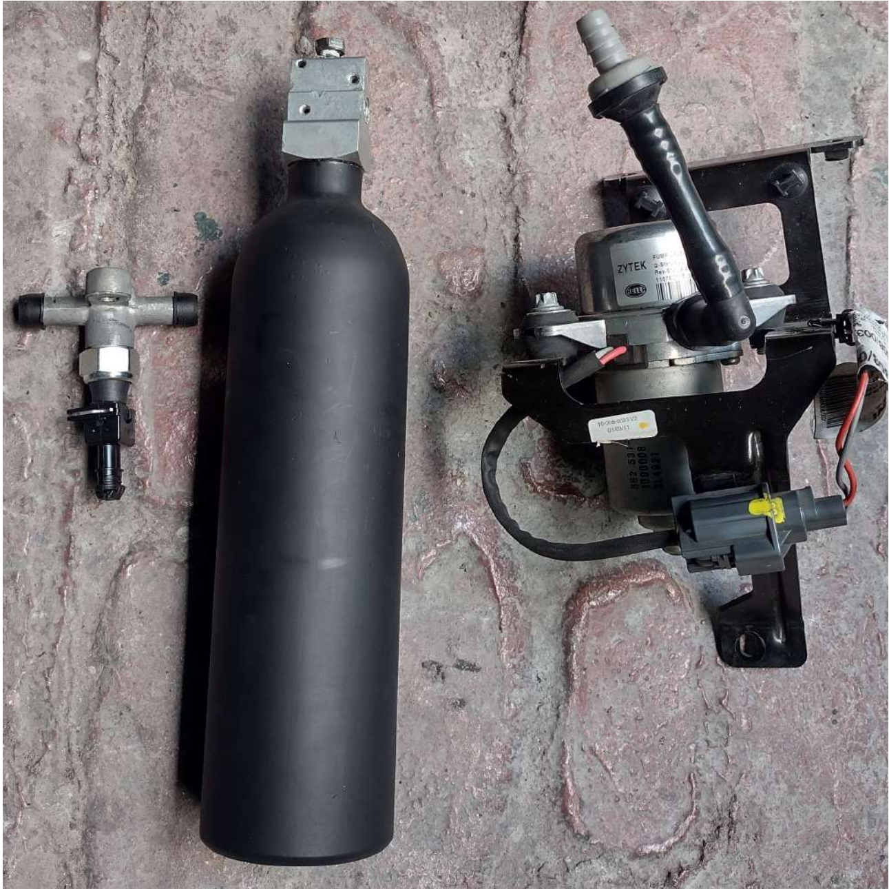
Figura 7.35: De izquierda a derecha, sensor de presión, tanque de almacenamiento, bomba de vacío
