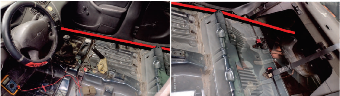
Figura 7.37: Ubicación del cableado de alto voltaje
