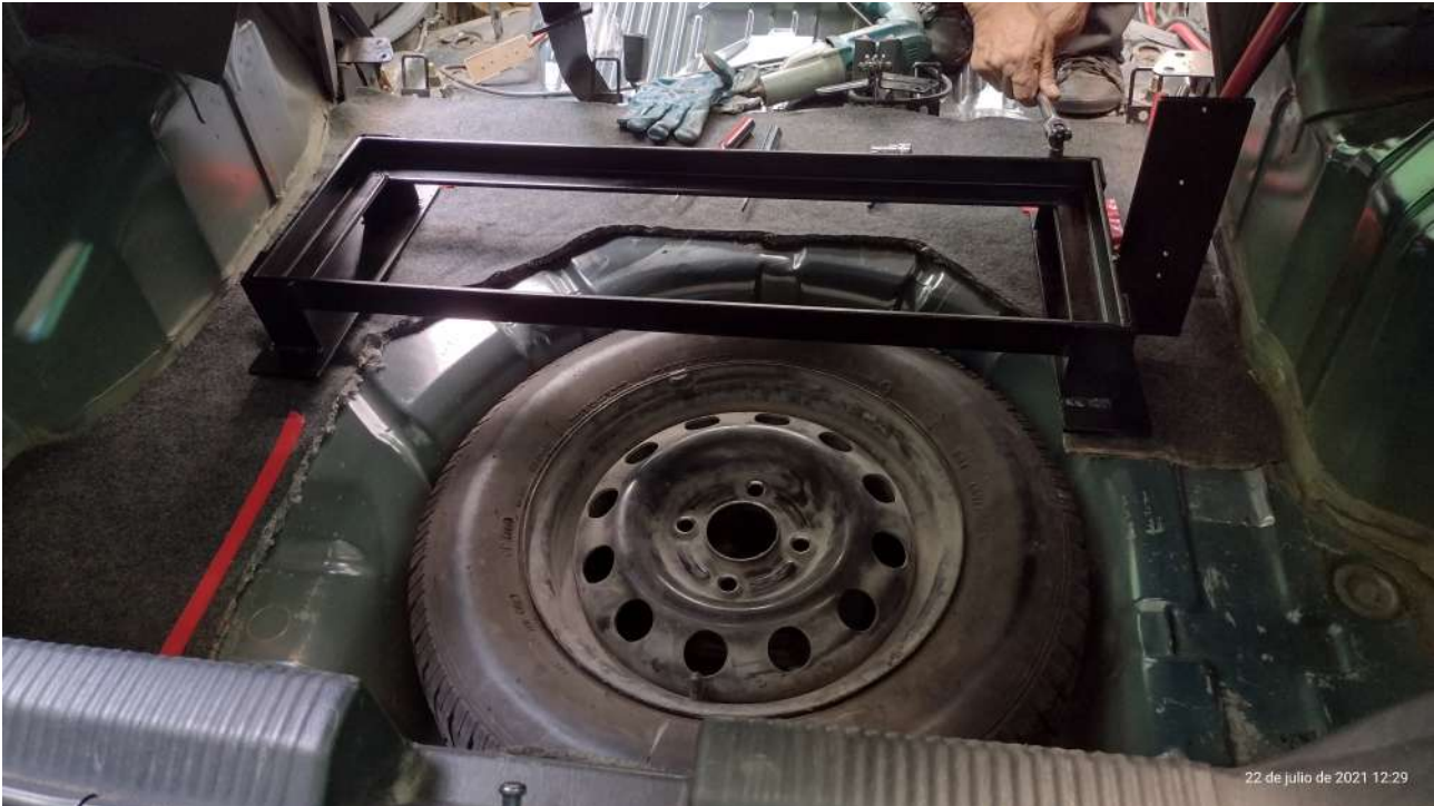
Figura 7.21: Soporte sobre llanta de refacción
