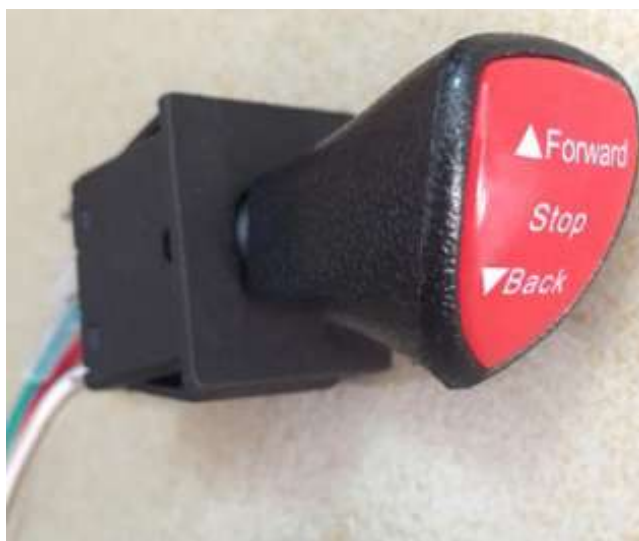
Figura 6.10: Ejemplo de palanca selectora asociada a la controladora
