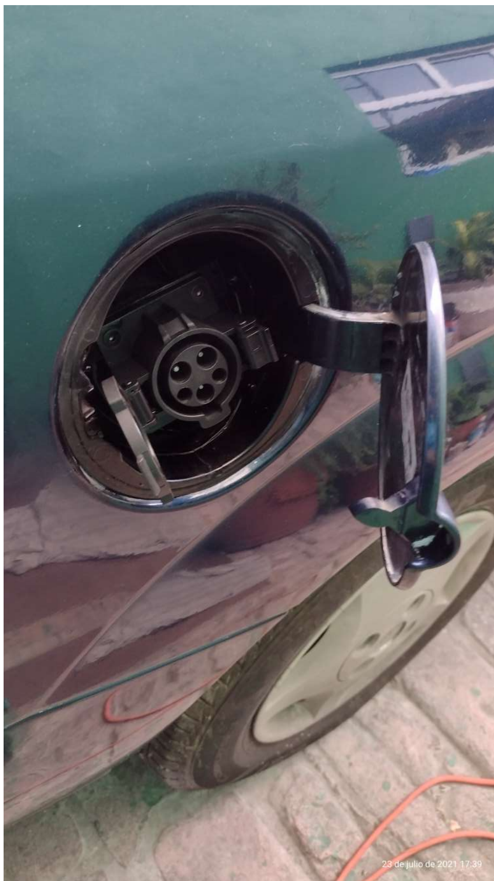
Figura 7.27: Ubicación de la toma para cargar al banco de baterías
