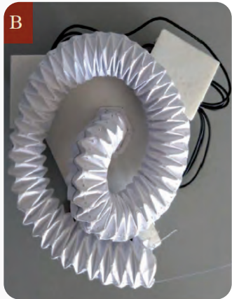
Figura 4. Estructura de refuerzo inspirada en origami, para direccionar un robot inflable [14]. A) Vista frontal, B) Vista superior.
